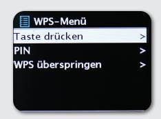
Als de router waarbij u de radio wilt registreren een WPS-functie heeft, kunt u hier de regel "druk op toets" selecteren. Activeer vervolgens de WPS-functie van uw router. Hierdoor wordt de verbinding automatisch tot stand gebracht. Raadpleeg de gebruikershandleiding van uw router voor informatie over de WPS-functie van uw router. Selecteer de regel "Skip WPS" als uw router geen WPS ondersteunt.
