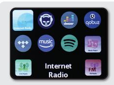
Druk op de MODUS-toets om het bronmenu van het apparaat te openen. Gebruik de pijltoetsen rechts/links om de internetradiobron te selecteren en bevestig met OK. Houd de Menu-toets ingedrukt totdat het hoofdmenu verschijnt.
