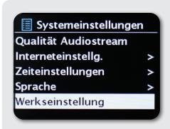
Hier kan de radio gereset worden naar de fabrieksinstellingen. Dit is nuttig als u wijzigingen hebt uitgevoerd die een niet optimale functie van het apparaat tot gevolg hebben. Met deze instelling wordt het apparaat gereset naar de toestand bij levering.
