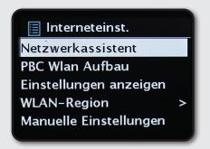
Selecteer het item Netwerkassistent en bevestig met OK. De radio toont dan alle beschikbare W-LAN-netwerken.
