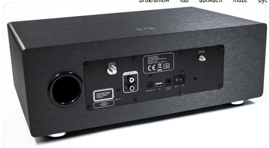
Z tyłu znajduje się analogowe i cyfrowe wejście audio. Można tu również podłączyć pamięci USB i dyski twarde USB (Zdjęcie: Block)
